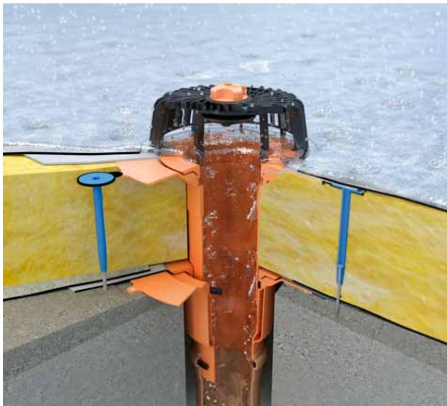
Střešní vpust s nástavcem na jednovrstevné střeše s povlakovou izolací
